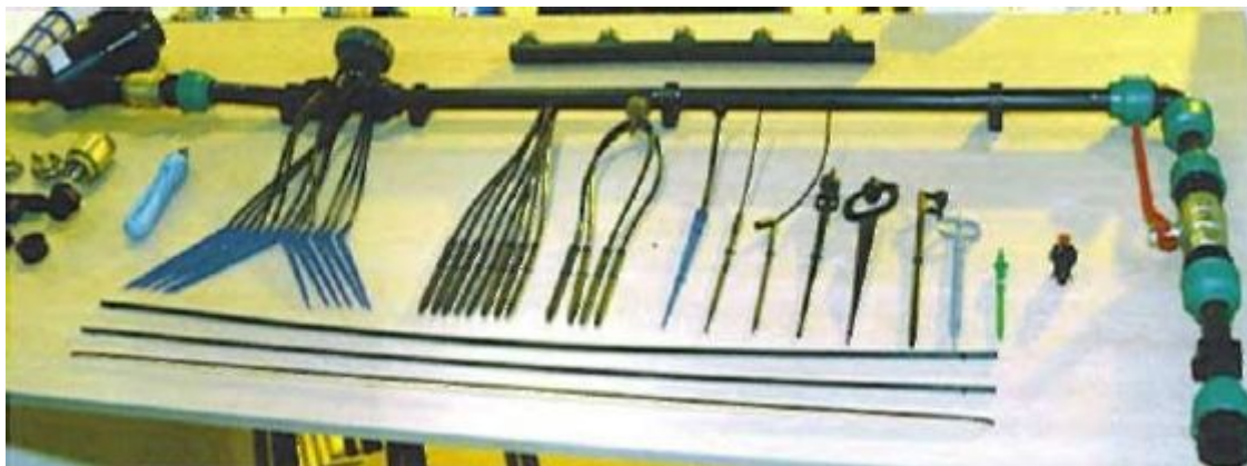
К главному трубопроводу крепится множество различных насадок, применяемых в гидропонных садах
