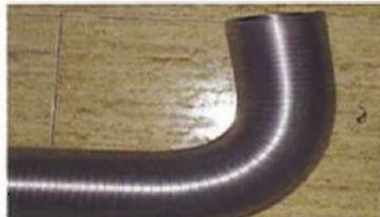
Сгиб под углом в 90 градусов «срезает» до 60% перемещенного воздуха.
