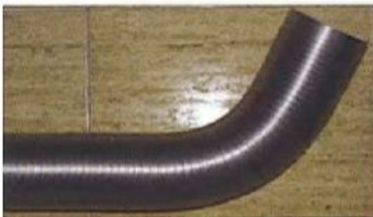
Сгиб под углом 45 градусов «срезает» до 40% перемещенного воздуха.
